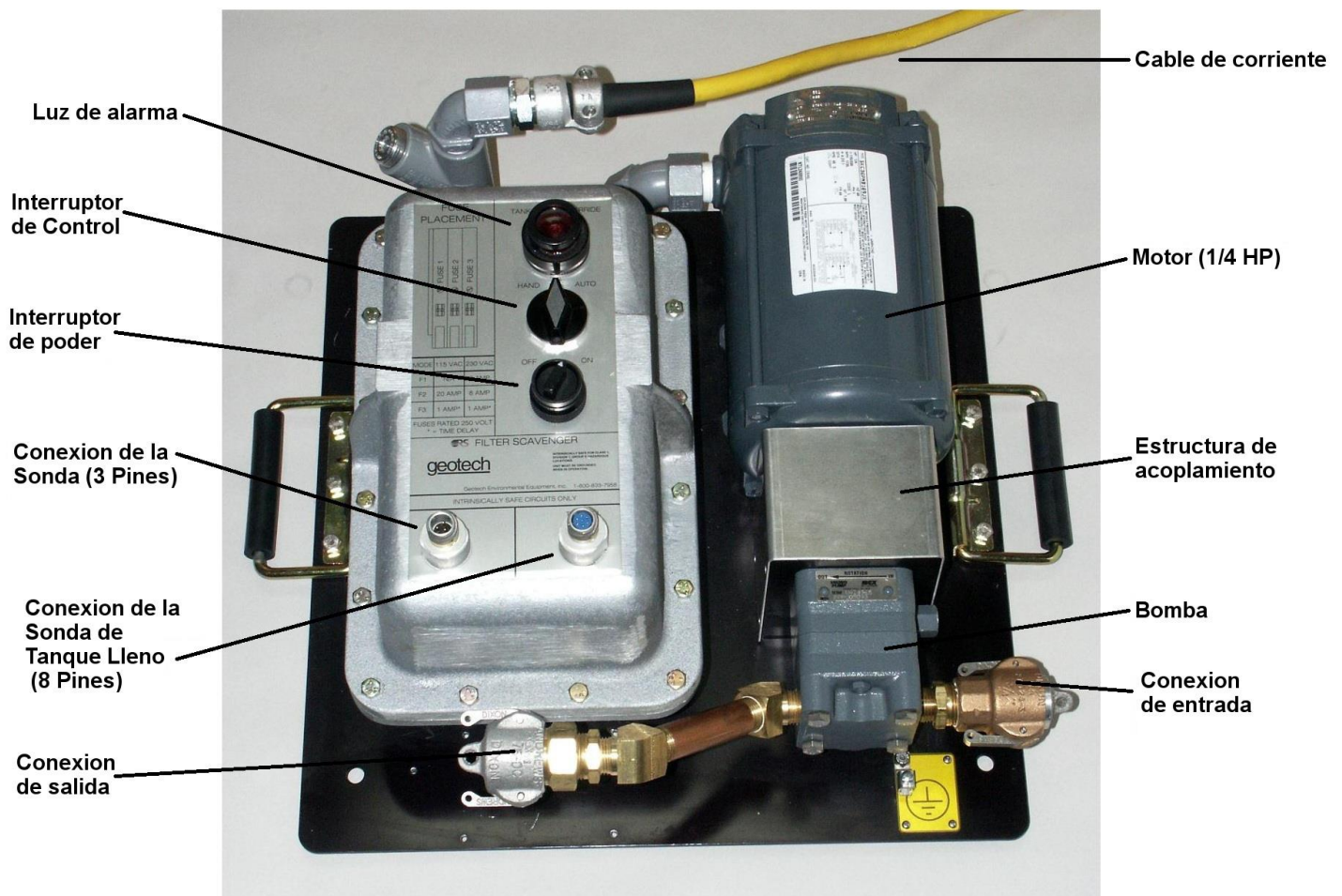
Figura 1-1 – Montaje del Módulo de Control de la Shallow Well Probe Scavenger
